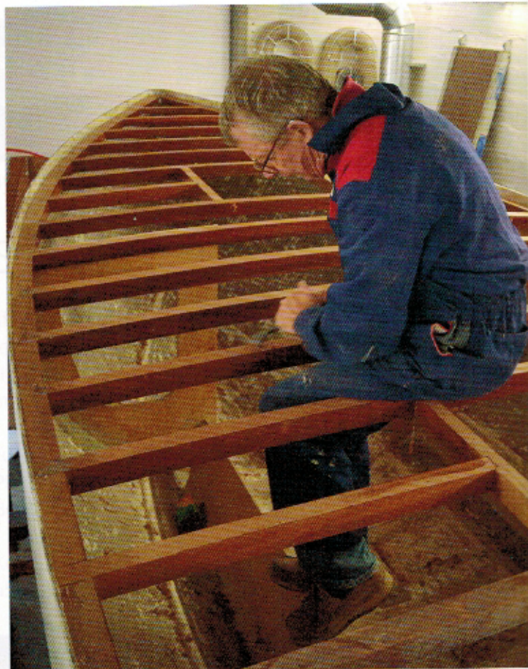
Den sidste tilpasning af dæksbjælkerne inden plywood-dækket bliver lagt på.
