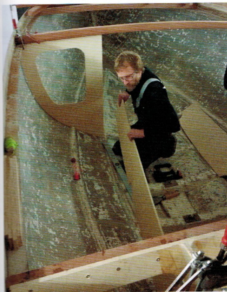
De langskibs afstivninger blev sat i, før dæksbjælkerne midtskibs blev monteret.
