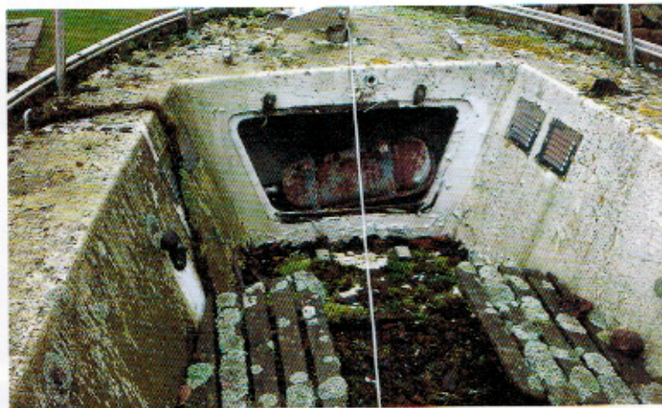
"Spækhuggeren" var i en særgelig forfatning, da den blev hentet i Rødvig. Prædikestolen agter og skødeskinnen på rælingen er ikke originalt som da Peter Bruun byggede båden.
