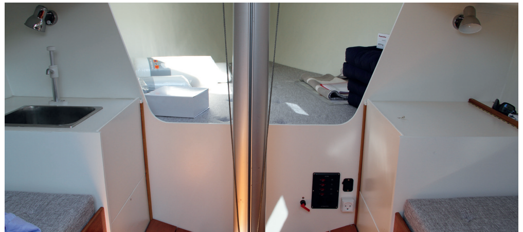
Alt blev hevet ud, og der blev bygget nyt i krydsfiner. Enkelt og praktisk. Bemærk vasken med håndpumpe i bb side.
