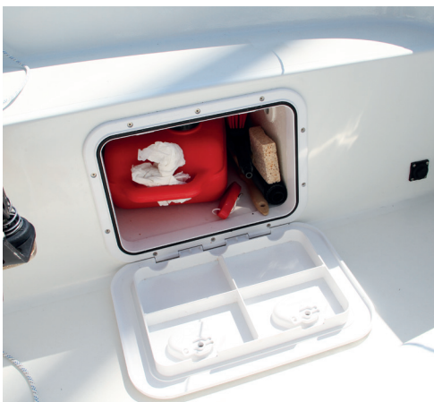
Benzintanken blev bygget i kistebænken, og slangen blev ført under dæk ud til påhængsmotoren.
