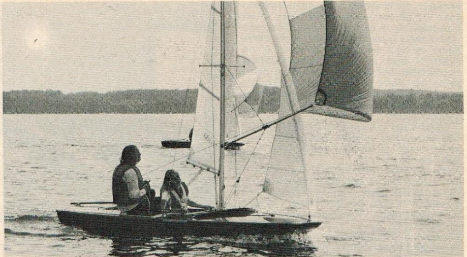
Flipper-jolle: (Konstrueret af Peer Bruun 1968): Mål: Længde: 4,04 m, bredde: 1,32 m, dybgang: 0,10 m (med sværdet oppe), vægt: minimum for skrog med flydemiddel, indstøbte klodser m.v. 70 kg. Pris: ca. 4500 kr. uden moms. Komplet sejlklar med spiler og spilerudstyr. For selvbyggere: Skrog komplet med flydemiddel og udskæringer 1475 kr., beslag til skrog 328 kr.,
