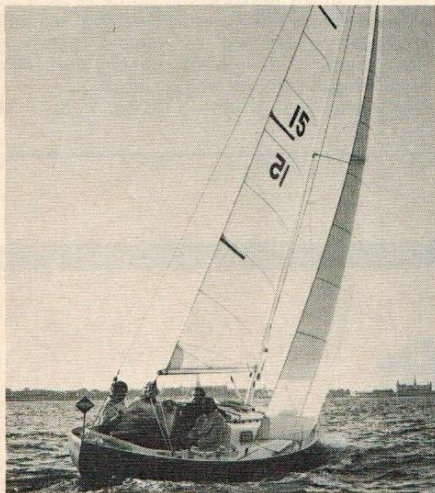
Spækhuggeren: (Konstrueret af Peter Bruun 1969): Mål: Længde: 7,50 m, bredde 2,33 m, dybgang: 1,45 m, ballastkøl: 1400 kg, sejlareal: 35 kvm. Pris: ca. 51.000 kr. uden moms. Sejlklar med aptering. For selvbyggere: Skrog med rorfinne af massiv fiberglas, dæk og ruf med skydekappe og garager samt to luger i fiberglasbalsa 16.000 kr. Skroget fås i farverne signalrød, mosgrøn, marineblå og sort, køl, 1400 kg støbejern, rør med rorstamme og rorhoved, rorbrønd, nylon komplet, faststøbning 4500 kr., bundbehandlingsmidler 250 kr., beslag på dæk, ræling, lugekarmer, håndlister m.v. komplet med skruer og bolte 4175 kr., mast, bom og rig, som kun leveres færdigmonteret, af specielle eloxerede aluminiumsprofiler, mast 120 mm, bom 80 mm, torpedoformet salingshorn, beslag, skruer, bolte, stålwirer til sejl 5321 kr., sejl, skøder og blokke 3820 kr., aptering og apteringsæt 4300 kr., korkbeklædning, kork 675 kr., velourisering, hynder 1600 kr. - ialt 39.041 kr. Alle priser er uden moms. Ekstraudstyr: Spiler 60 kvm 1700 kr., spilerudstyr med spilerstage, beslag m.v. 650 kr., vindindikator 100 kr., lanterner, kombineret toplanterne komplet med akkumulator, akkumulatorkasse og installation 800 kr., anker, 123 kg med 12 mm ankerlinekæde 275 kr., fendere, 4 stk. med stropper 100 kr., garderobeskab i teaktræ 650 kr., 2 stk. hylder til kahyt med rørbeslag 250 kr., kogeapparat 325 kr.
