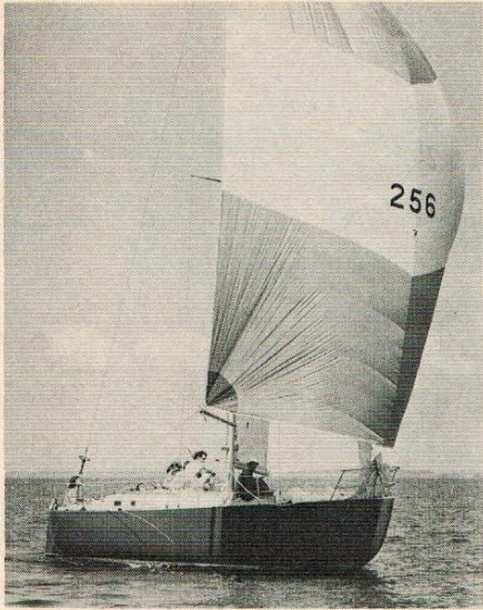
Kaskelotten: (Konstrueret af Peter Bruun 1971). Mål: Længde 10,30 m, bredde 3,30 m, dybgang 1,75 m, samlet sejlareal 75 kvm, spiler ca. 90-100 kvm, displacement 5750 kg. Pris: Godt 200.000 kr., oplyser Peer Bruun, som endnu ikke er i stand til at give yderligere oplysninger om Kaskelotten, men den ventes fremstillet i et antal af 5 om året og skal både være en havkrydser, familiebåd og flydende sommerhus med fuld ståhøjde overalt under dæk. Skrogets facon er en videreførelse af Spækhuggerens.
